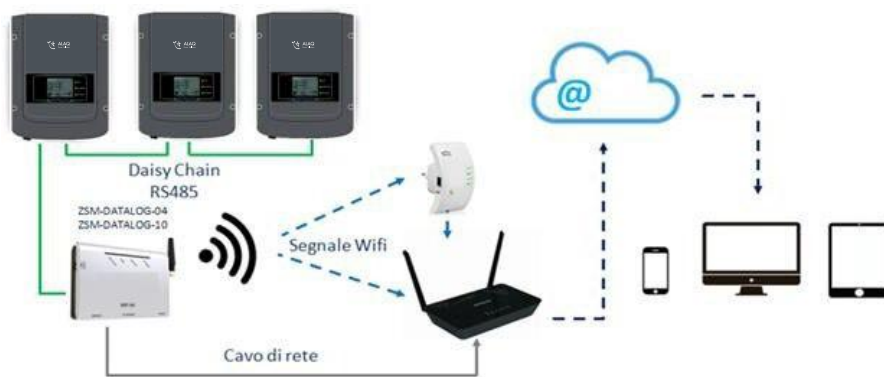
Figure 65 – Schéma de connexion du datalogger APS-DATALOG-04 / APS-DATALOG-10
