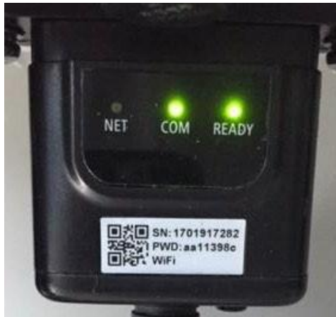
Figure 48 – État de communication irrégulière entre Wi-Fi et serveur à distance
