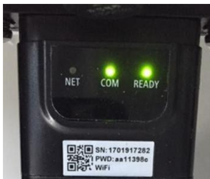
Figure 64 – État de communication irrégulière entre adaptateur et serveur à distance
