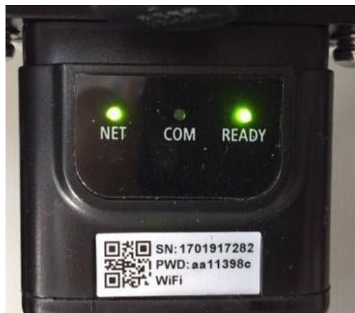
Figure 57 – État de communication irrégulière entre onduleur et adaptateur
