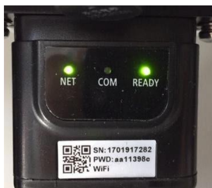
Figure 63 – État de communication irrégulière entre onduleur et adaptateur
