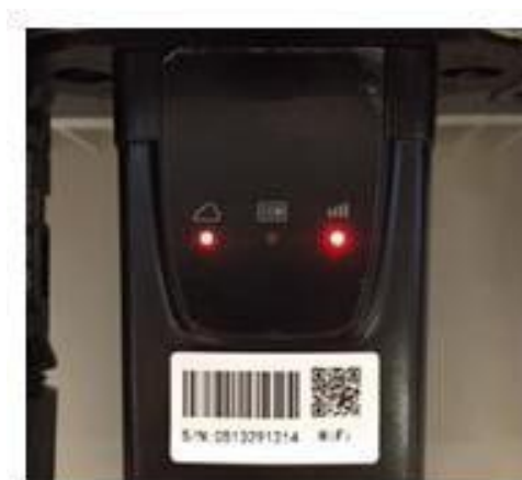
Figure 46 – État de communication irrégulière entre onduleur et Wi-Fi
