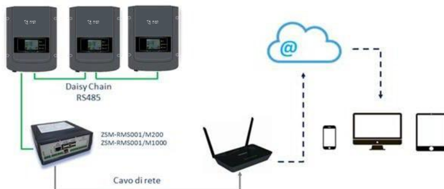
Figure 66 – Schéma illustrant le fonctionnement du datalogger APS-RMS001/M200 / APS-RMS001/M1000
