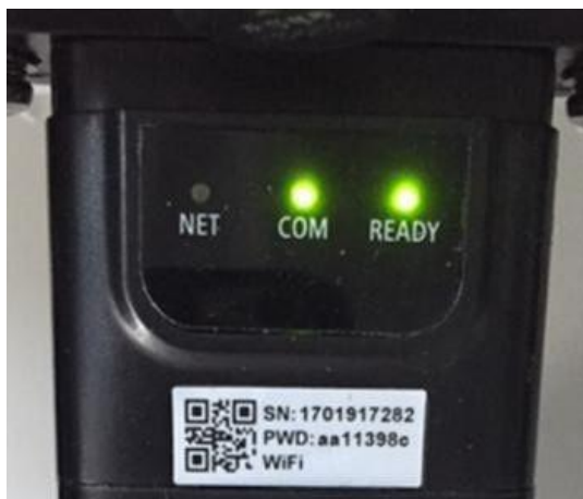
Figure 58 – État de communication irrégulière entre adaptateur et serveur à distance
