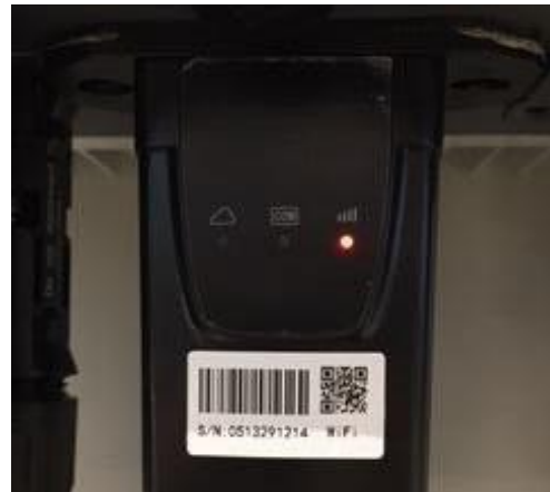
Figure 48 – État de communication irrégulière entre Wi-Fi et serveur à distance
