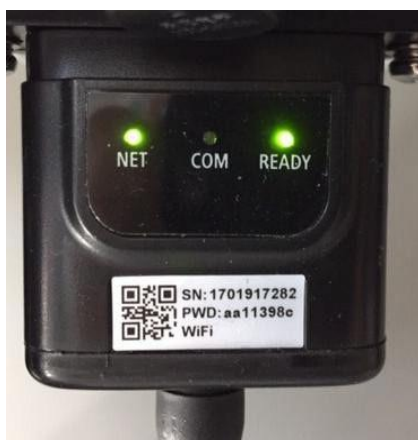
Figure 46 – État de communication irrégulière entre onduleur et Wi-Fi
