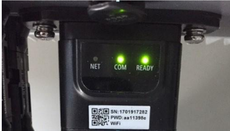
Figure 70 – État initial des LED
