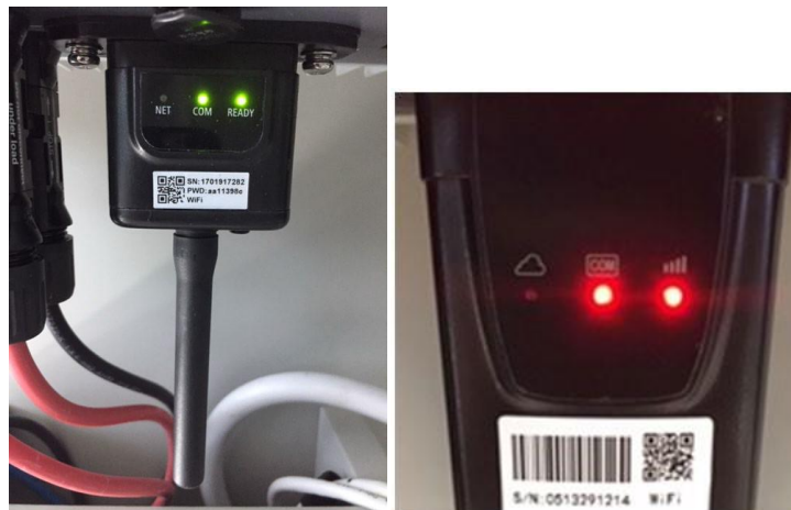
Figure 59 – État initial des LED
