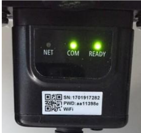
Figure 64 – État de communication irrégulière entre Wi-Fi et serveur à distance
