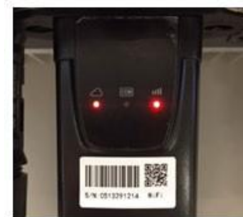
Figure 62 – État de communication irrégulière entre onduleur et Wi-Fi
