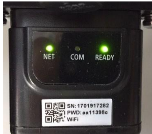
Figure 72 – État de communication irrégulière entre onduleur et adaptateur
