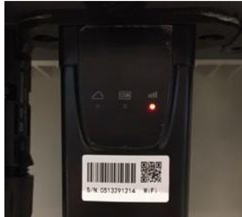
Figure 64 – État de communication irrégulière entre Wi-Fi et serveur à distance
