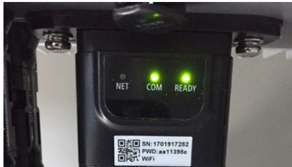
Figure 76 – État initial des LED
