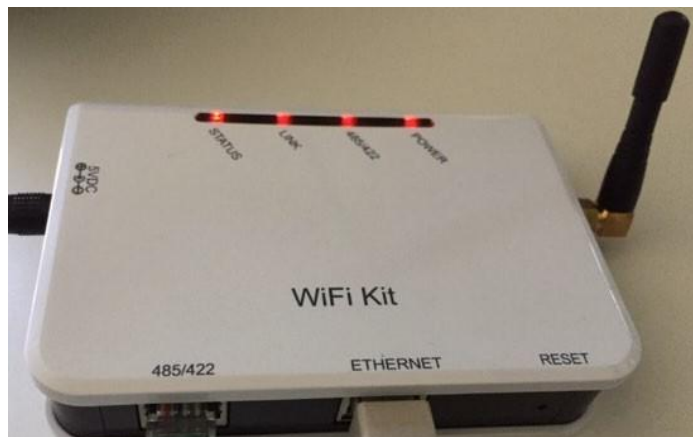
Figure 101 – LED qui indique la configuration correcte du datalogger
