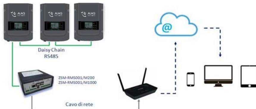
Figure 81 – Schéma illustrant le fonctionnement du datalogger ALAQ-RMS001/M200 / ALAQ-RMS001/M1000
