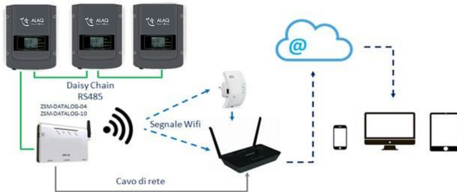
Figure 80 – Schéma de connexion du datalogger ALAQ-DATALOG-04 / ALAQ-DATALOG-10
