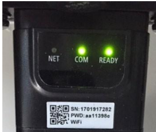
Figure 73 – État de communication irrégulière entre adaptateur et serveur à distance
