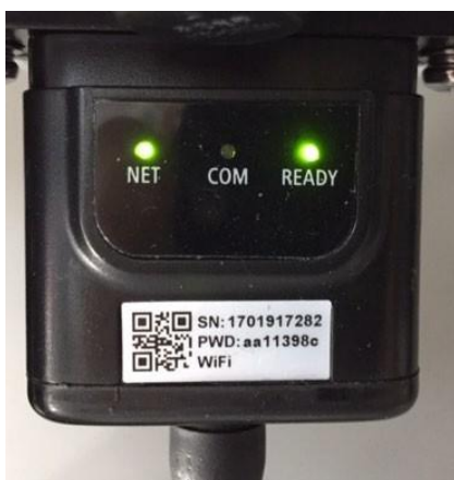
Figure 62 – État de communication irrégulière entre onduleur et Wi-Fi
