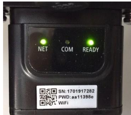
Figure 78 – État de communication irrégulière entre onduleur et adaptateur
