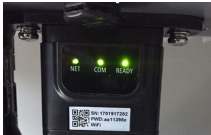
Figure 71 – État final des LED
