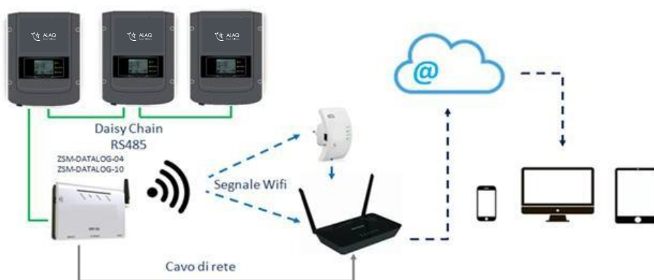
Figure 73 – Schéma de connexion du datalogger ALAQ-DATALOG-04 / ALAQ-DATALOG-10
