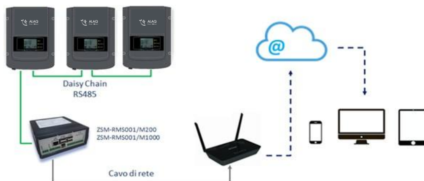
Figure 74 – Schéma fonctionnel du datalogger ALAQ-RMS001/M200 / ALAQ-RMS001/M1000
